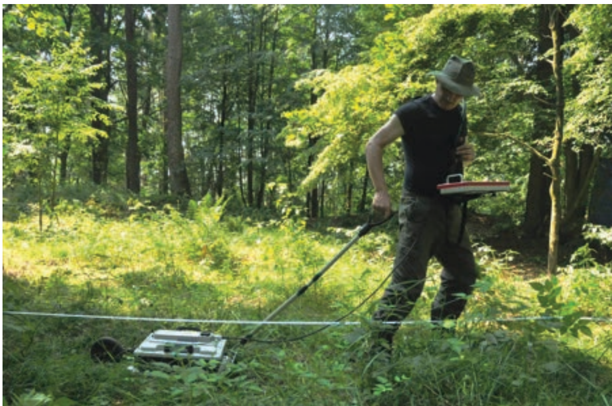
Ryc. 2. Prospekcja nieinwazyjna z wykorzystaniem metody GPR (fot. K. Rabięga)
